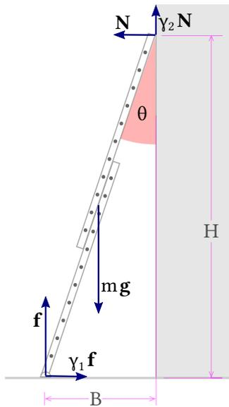
Die Skizze links zeigt eine Leiter, die an einer Wand lehnt. Sie ist angestellt mit einem Winkel  $\theta$  zur Vertikalen und es wirken folgende Kräfte:
