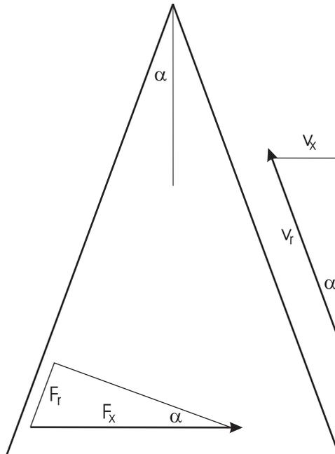
Abbildung 1: Coriolis-Effekt auf der Oberfläche eines Kegels.
